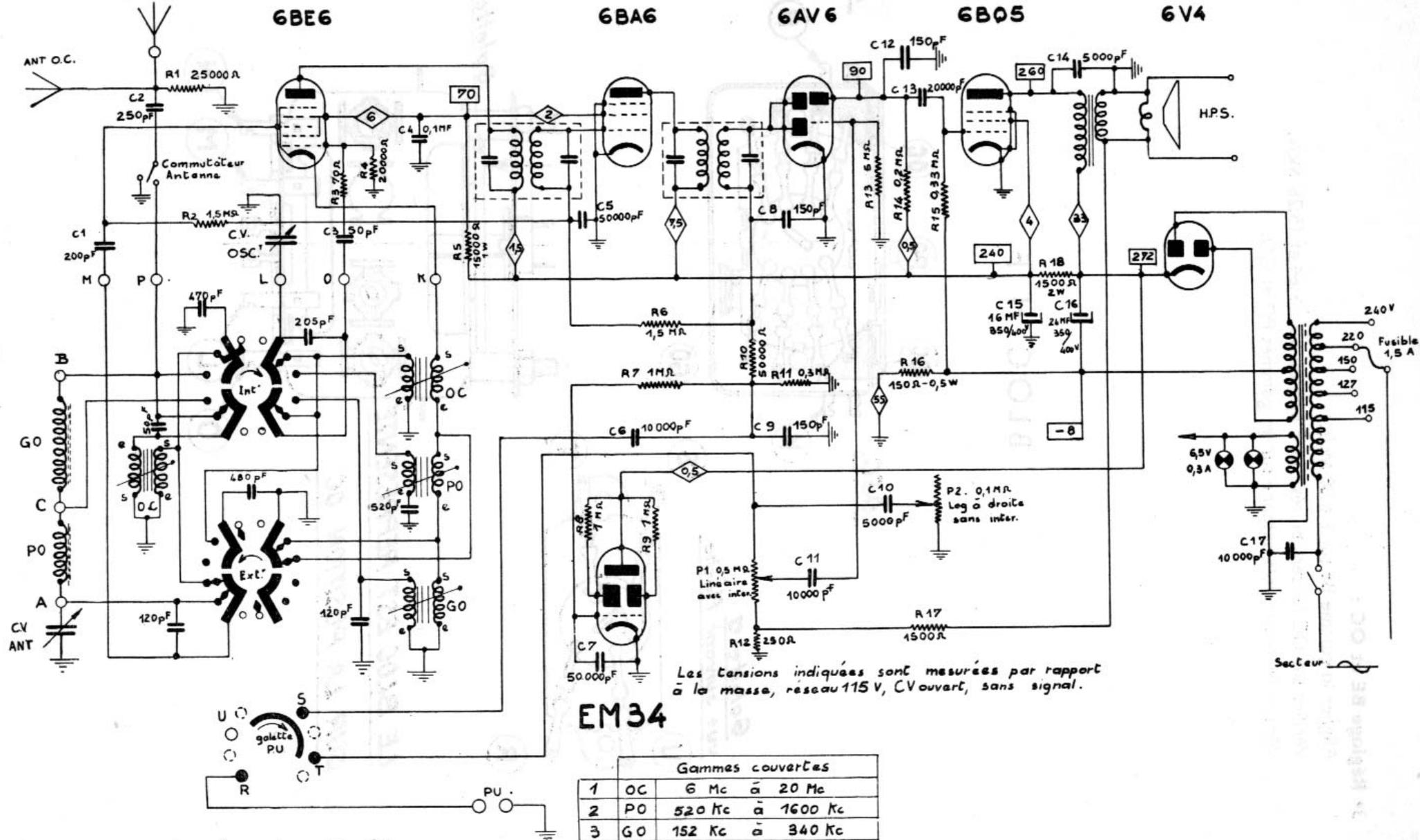
Les tensions indiquées sont mesurées par rapport à la masse, réseau 115 V, CV ouvert, sans signal.
