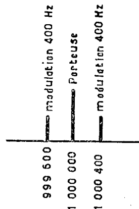
FIG. 109. — Modulation par 400 p/s d'une onde de 1 000 000 p/s.
