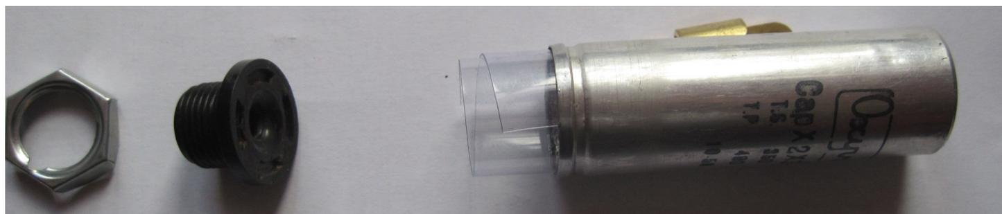
Donc ici, on voit que le bord du tube n'a subi aucune déformation en utilisant la seconde méthode, ce qui ne serait pas le cas avec un dessertissage.
