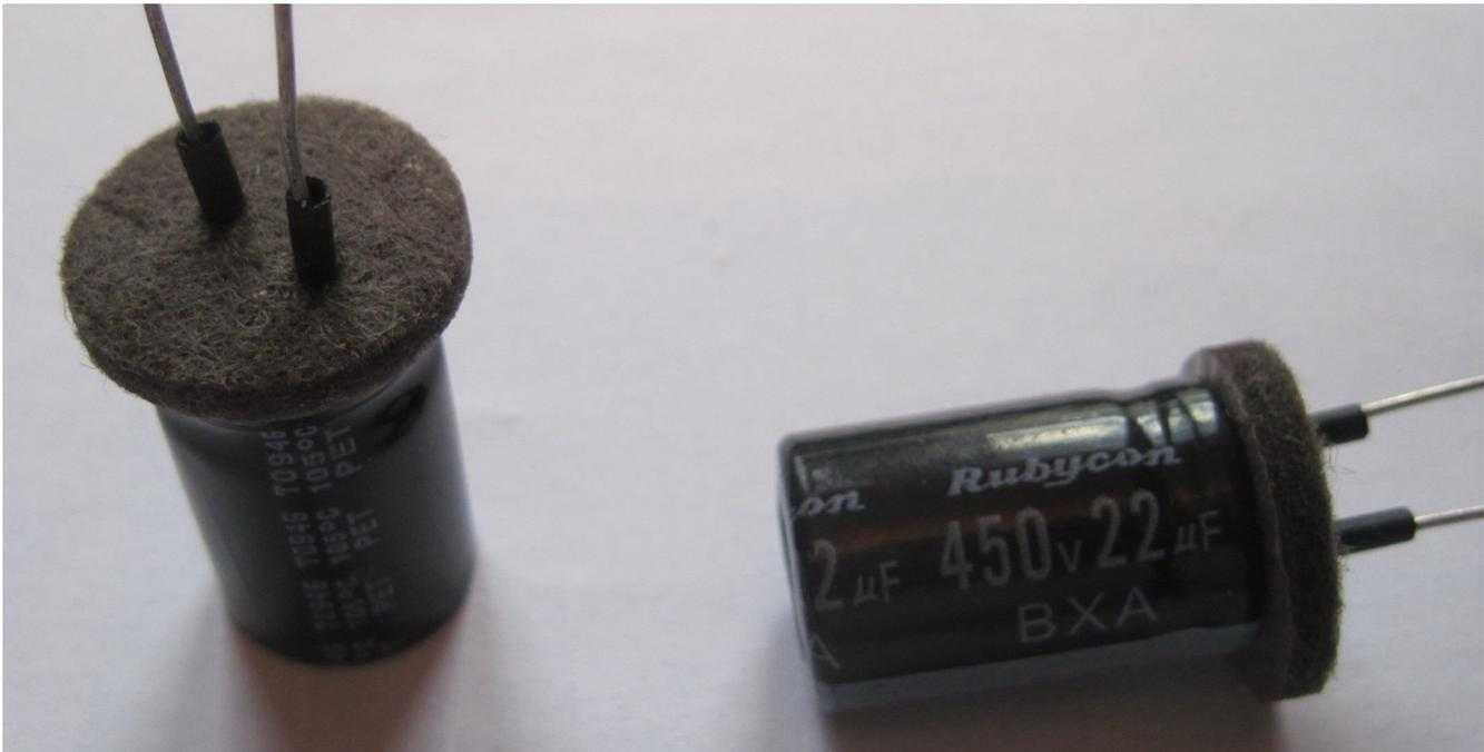
Je prépare les deux condensateurs de la même façon. Je choisis des feutres qui ne remplissent pas complètement le tube alu car les fils du condensateur du fond devront pouvoir passer sur les côtés. Les rondelles de feutre sont percées de deux trous faits à la pointe à tracer dans lesquels j'introduis deux petits tronçons de gaine thermorétractable. Puis je présente le condensateur du côté collant pour l'immobiliser sur le feutre.
