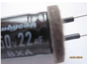
Soudure du fil noir (côté négatif) et présentation d'un morceau de gaine de diamètre supérieur à la précédente destinée à tout recouvrir jusqu'au feutre
