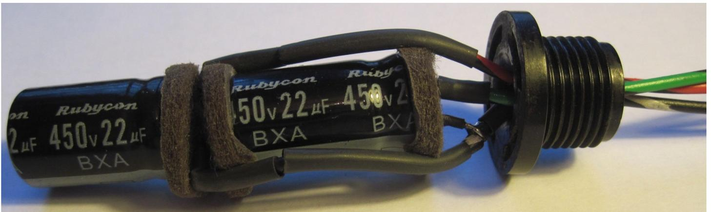
Travail terminé. Mais par prudence, mesurer les condensateurs avec un capacimètre avant emboîtement et collage
