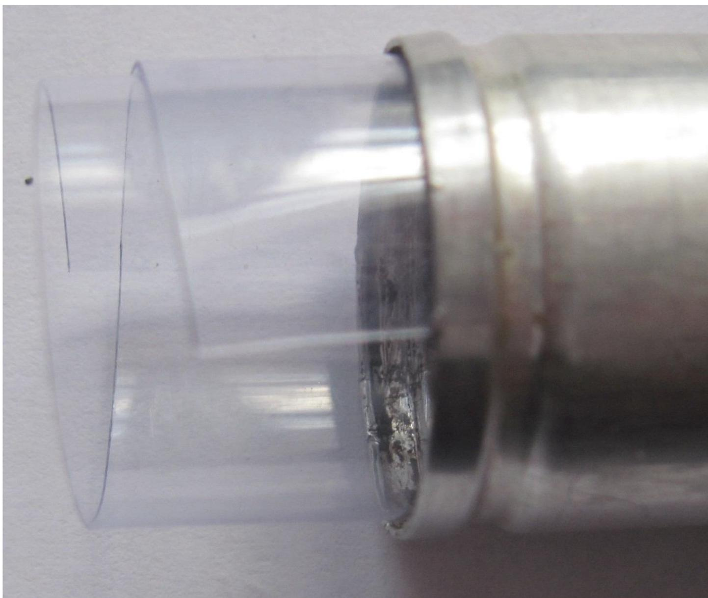
Gros plan sur l'isolant qui fait un tour et demi. Il n'y a plus qu'à l'enfoncer jusqu'au bout et loger au fond la rondelle d'isolant sur laquelle est placé le feutre adhésif.
