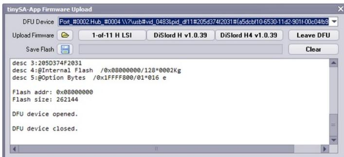
Clic sur "Upload Firmware" et aller récupérer le fichier de firmware à installer (type \*.dfu).
