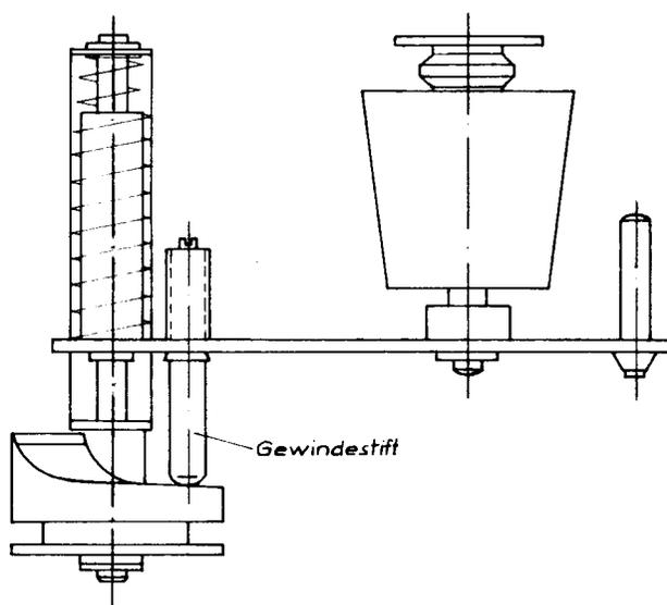
Durch Drehen des Gewindestiftes im Uhrzeigersinn wird die Drehzahl größer. Bei eingebautem Gerät kann das Kurvenstück von außen in richtige Stellung gebracht werden.
