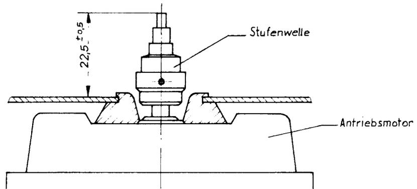
Die Stufenwelle wird auf das Maß  $22,5 \pm 0,5$  mm eingestellt.
