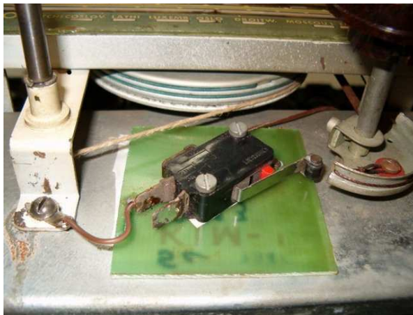
Figure 3a. - Un commutateur qui commande le plot B6
