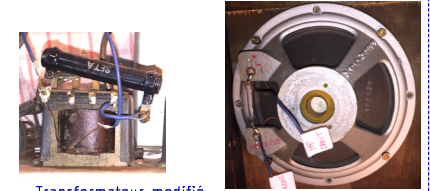
Transformateur modifié. Primaire environ 157 ohms. Vérifier valeur du secondaire (cc 0.8 ohms)
