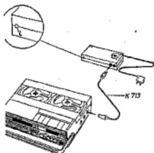
Tonbandgerätes her und schließen Sie das Netzgerät an der Steckdose an. Der Akkumulator ist im Batteriefach eingesetzt. Das Tonbandgerät selbst wird nicht eingeschaltet. Am Netzgerät leuchtet nun die grüne Kontrolllampe L auf und zeigt an, daß der Akkumulator geladen wird. Ist die Ladung beendet, so erlischt die Lampe.
