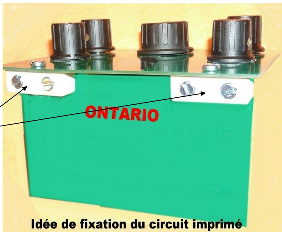
Tasseaux section carrée en bois couleur blanc, fixés par vis et écrou de 3 mm ISO
