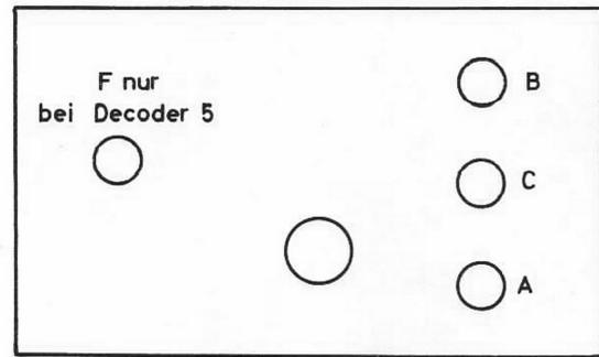
Der Nachgleich des Stereo-Decoders zusammen mit dem Stereo-Rundfunkgerät auf maximale Übersprechdämpfung kann nur mit speziellen Testsendungen der Stereo-Rundfunksender oder in Verbindung mit einem geeigneten Stereo-Signalgenerator exakt durchgeführt werden. Für den Fall, daß die Abgleichmöglichkeiten nicht gegeben sind, sollte von einem Nachgleich Abstand genommen werden. Er ist in den meisten Fällen auch nicht erforderlich, da die Decoder bereits im Werk vorabgeglichen sind.
