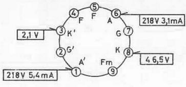
Spannungen mit Grundig-Röhrevoltmeter bei 220 V = Betriebsspannung ohne Eingangssignal gegen Masse gemessen.
