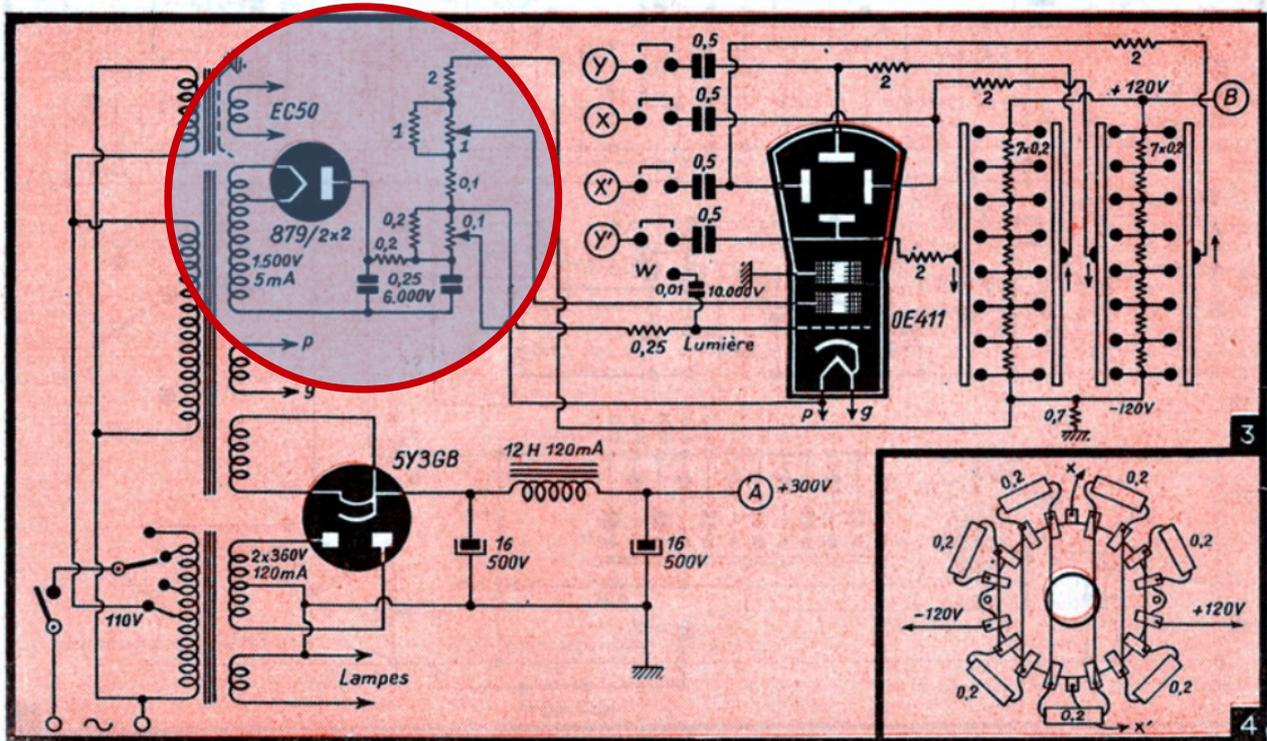
Fig. 3. — Schéma général de l'alimentation de l'oscilloscope et son tube cathodique.
