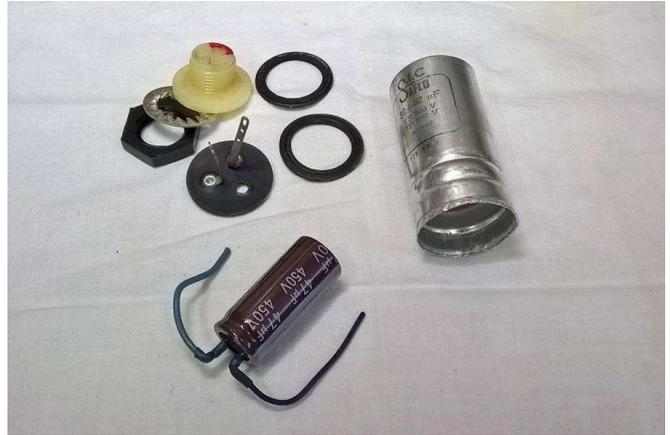
3) Je câble mes Trois nouveaux Condensateurs Chimiques ( $68\mu\text{f}$ ,  $47\mu\text{f}$  et  $33\mu\text{f}$ ), le Fil Négatif (Noir) et le Fil Positif (Bleu) sur les Cosses de Sortie. Les soudures de connections seront Isolés avec de la Gaine thermo rétractable.
