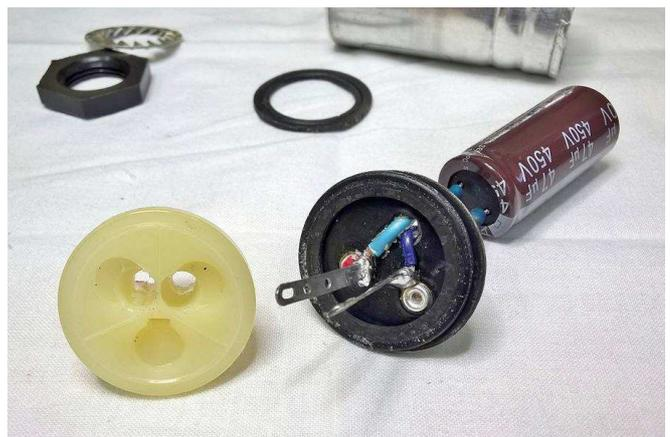
4) Les Trois Condensateurs ainsi câblés (Fils souples), sont glissés délicatement dans leur tube Alu équipé de son Isolant Plexi. L'ensemble des Pièces remises en place, il ne suffit plus que de Rabattre proprement le rebord du Tube Alu.
