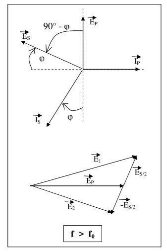
On remarque sur les figures ci-dessus, que l'angle  $\phi$  est > 0 (sens anti-horlogique) pour  $f < f_0$  et < 0 pour  $f > f_0$ . En prenant le vecteur  $\overrightarrow{E_P}$  comme référence, on peut écrire, en utilisant directement les amplitudes complexes: 1) pour  $f = f_0$  ( $\phi = 0$ )
