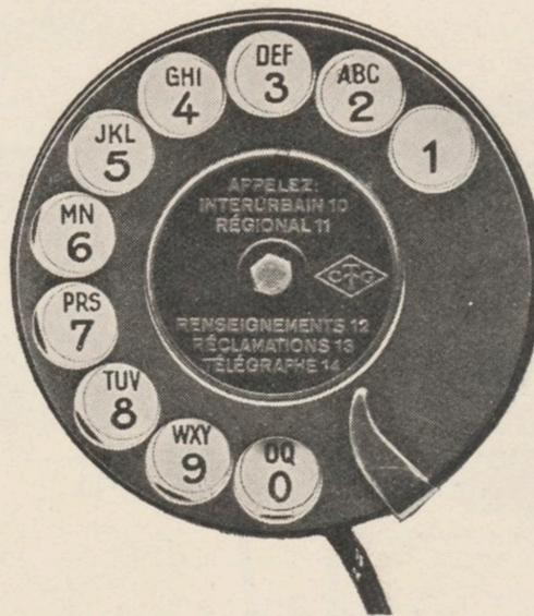
FIG. 3. — Cadran d'appel pour appareil d'abonné dans le réseau automatique de Paris.
