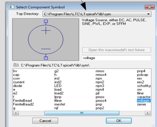
On obtient le symbole suivant dans **Schematic** pour une source de tension
