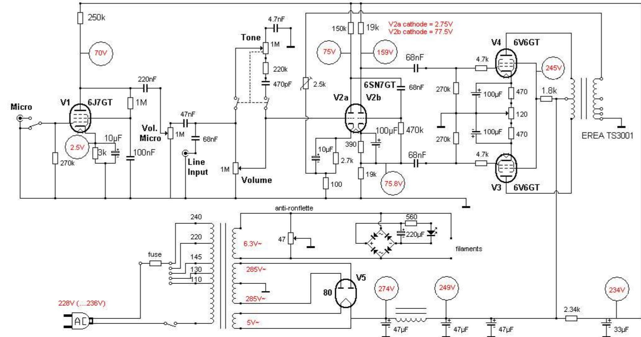
ajouté contrôle tonalité, fiche micro avec switch, branchement transfo sur 240V
