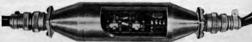
Ligne téléphonique équipée d'un amplificateur miniature à transistrons.
