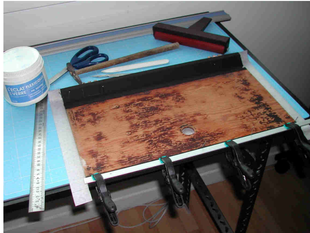
Entoilage de la trappe arrière
