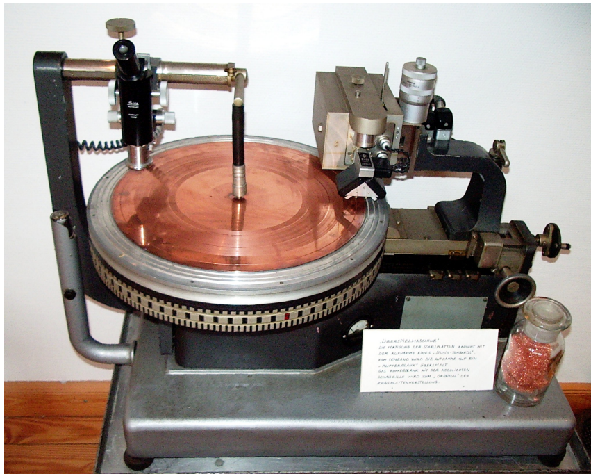
Illustration 2: Système de gravure du disque ici en cuivre. On peut remarquer le stroboscope sur l'épaisseur du plateau permettant de surveiller la vitesse de rotation.
