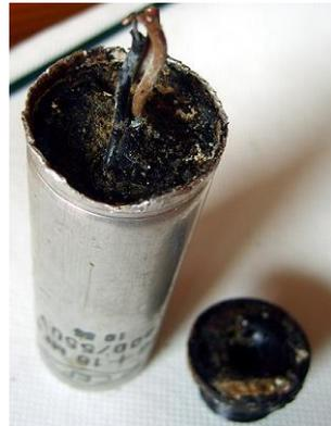
L'opération suivante consiste à chauffer le corps alu au décapeur thermique pour ramollir le brai, pour extraire l'intérieur.
