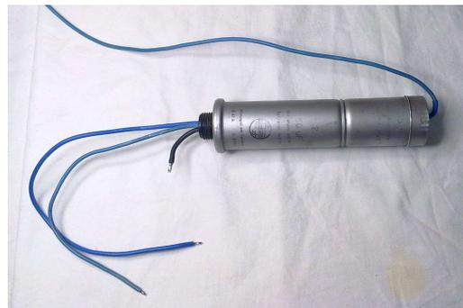
**2b)** Pour les condensateurs étanches (sans Couvercle), Découper délicatement le Haut du Tube Alu à la scie à métaux à un Centimètre du bord et ébavurer. Au Ciseau, faire 2 entailles verticale à 180° sur 6 à 8 m/m sur le Haut du Tube Alu pour pouvoir diminuer le Diamètre de celui-ci par pincement. Cela permettra de placer le Couvercle et de le refermer sans bricoler.
