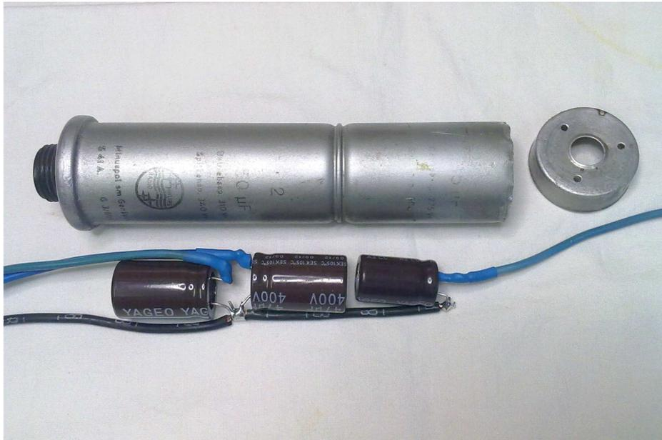
L'Ensemble des 3 Condensateurs ainsi câblés (Fils souples), est glissé délicatement dans le tube Alu équipé de son Isolant Plexi et pour finir, une rondelle Plexi (Diamètre du Tube Alu) avec un trou passe fil et l'on peut emboîter le Couvercle.
