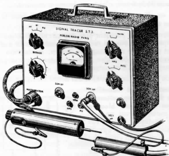
Figure 99. - Le signal-tracer ST.3 avec le multivibrateur et la sonde détectrice.
