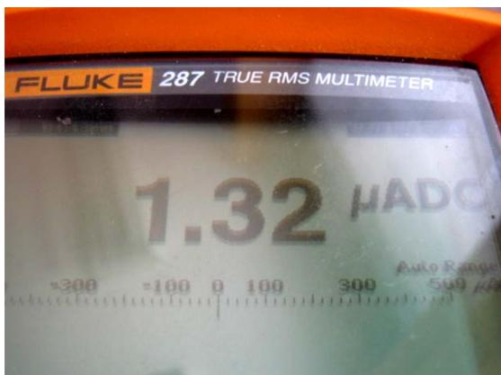
Le courant de repos est conforme à la spécification.
