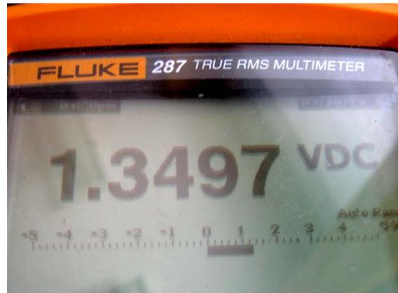
On constate une très légère chute de la tension de sortie du régulateur à charge maximum, sans conséquence significative sur la précision de mesure.
