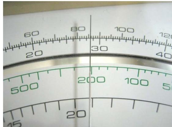
20k $\Omega$ , calibre  $\Omega \times 100$
