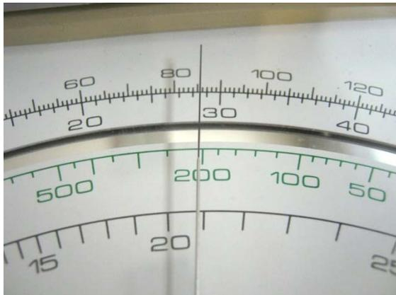
2k $\Omega$ , calibre  $\Omega \times 10$
