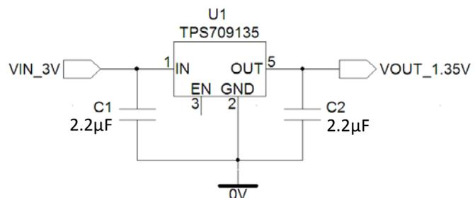
Deux condensateurs de découplage de 2,2µF, en entrée et en sortie du régulateur, assurent sa stabilité.
