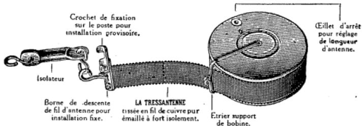
*Sa constitution.* — La "Tressantenne" est un nouveau système d'antenne pour T. S. F. consistant en une tresse plate très légère, dont la chaîne et la trame sont constituées par des fils très fins tous isolés.
