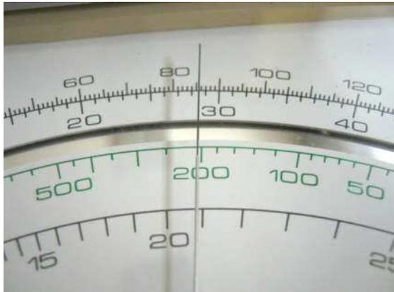
2k $\Omega$ , calibre  $\Omega \times 10$
