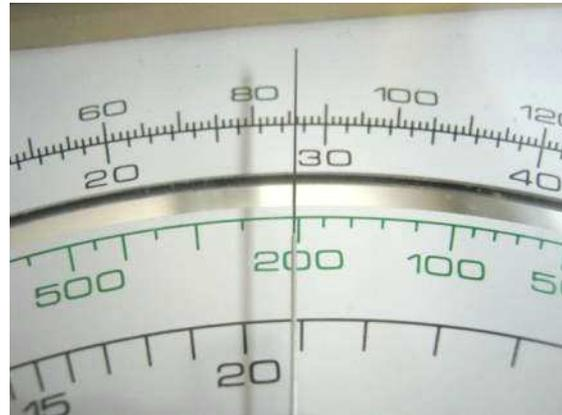
20k $\Omega$ , calibre  $\Omega \times 100$
