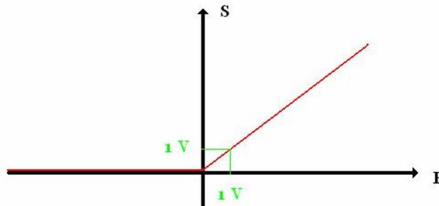
La théorie et la pratique sont cohérentes car à l'aide de SPICE nous trouvons exactement les mêmes caractéristiques. Le montage nous permet donc de réaliser un redressement sans seuil, ne laissant passer que les tensions positives de  $V_e$ .
