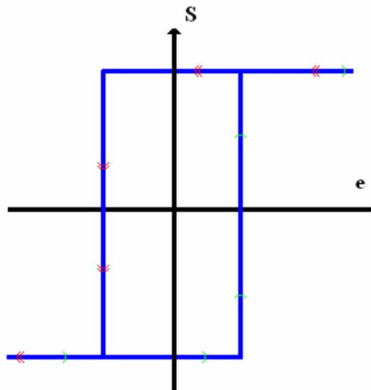
Nous obtenons donc bien un trigger de schmitt non inverseur centrée sur 0V et possédant une largeur de porte de 2 V.
