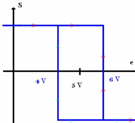
Nous obtenons la caractéristique voulue, qui est une hystérésis centrée sur 5 V, dont la largeur de la porte est de 2 V.
