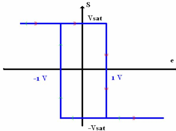
Nous retrouvons bien les conditions imposées sur les niveaux de basculement de la porte. Ce circuit est appelé bascule de Schmitt ou trigger de Schmitt car il possède deux seuils de basculement.
